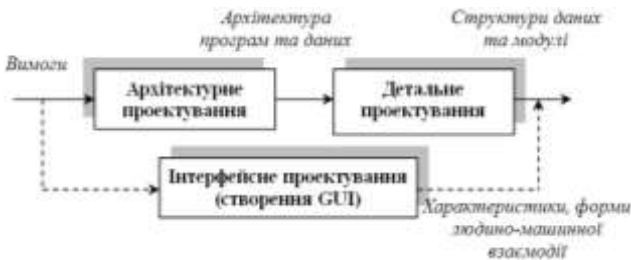
Рисунок 4.6 – Інформаційні зв'язки процесу проектування системи автоматизації
